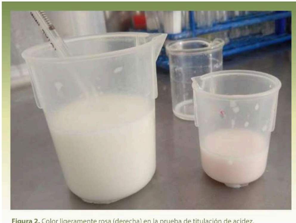
Figura 2. Color ligeramente rosa (derecha) en la prueba de titulación de acidez.
